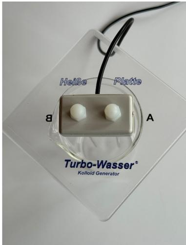
Die „Heiße Platte“ hat hauptsächlich zwei Funktionen. Die erste ist die, dass der Generator nicht mehr auf dem Gefäß sitzen muss, weil die Platte eine Verlängerung der Elektrodenanschlüsse darstellt. Damit ist gleichzeitig das Thema Feuchtigkeit am Generator selbst weg und dieser liegt entspannt neben dem Gefäß auf dem Tisch, wodurch er sich auch angenehmer bedienen lässt. Als Nebeneffekt wird der ganze Prozess im wahrsten Sinne transparenter.
